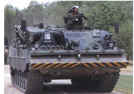
Der Bergepanzer Büffel wiegt 58,6 t. Anhängelast 63 t. Fährt 68 km/h.
