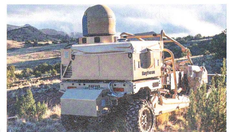
Lasergestütztes Drohnenabwehrsystem auf Polaris Geländefahrzeug.
