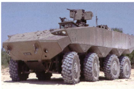
Neuer Radschützenpanzer Eitan APC mit Iron Fist Selbstschutzsystem.
