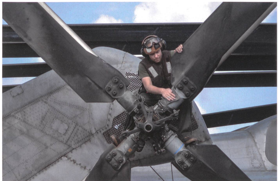
Golf von Oman: Sergeant Mecklin wartet auf dem Flugdeck des amphibischen Landungsschiffes USS Kearsarge den Rotor eines CH-53E-Super-Stallion-Helikopters.
