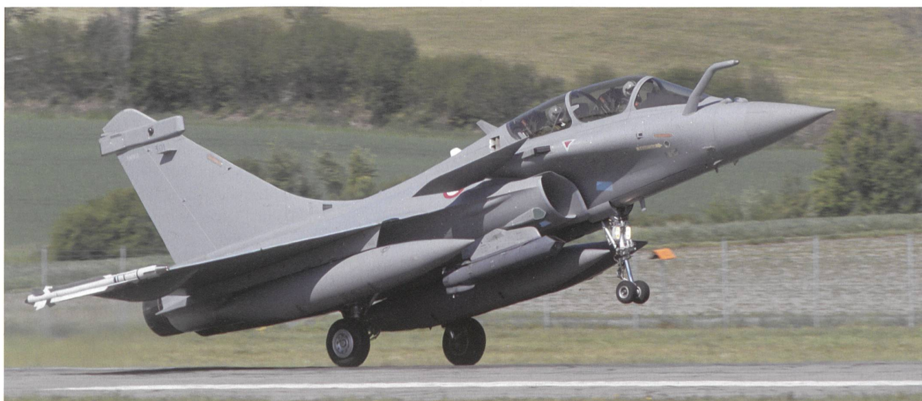
Der Rafale verfügt über eine Aussenlastzuladung von bis zu 9,5 Tonnen.
