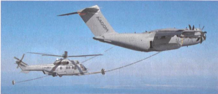
Luftbetankungsversuch der A400M mit einem Helikopter.
