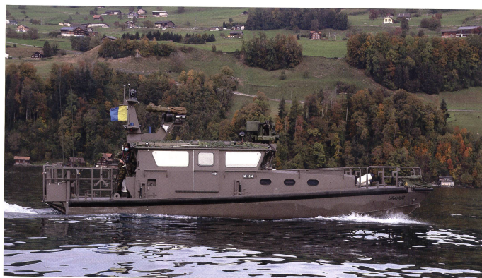
Das Patr Boot 16 verfügt über eine Crew von 7 Mann und ist mit einer 12,5-mm Kongsberg-Waffenstation ausgerüstet.
