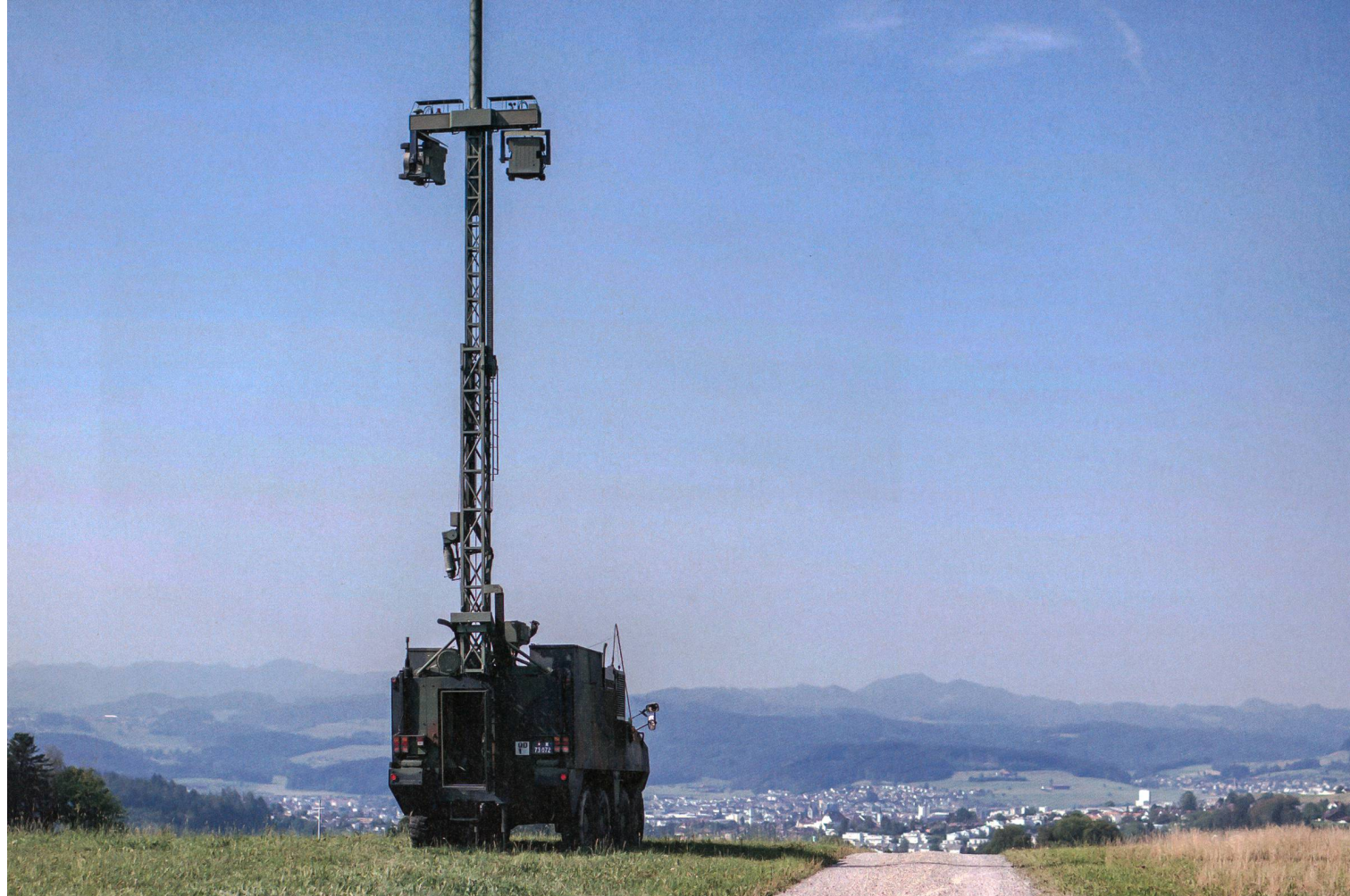
Der RAP Panzer ist ein zentrales Element für die Sicherstellung der Verbindungen zwischen den einzelnen Beteiligten der Übung.
