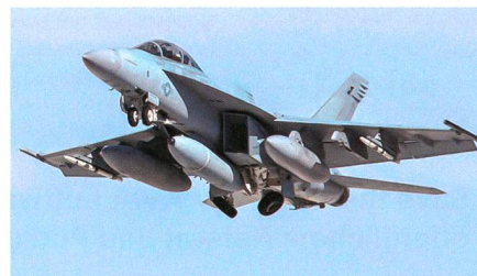
Super Hornet mit IRST-Block II-Behälter.
