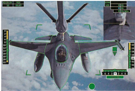
Automatische Luftbetankungsanlage A3R von Airbus.
