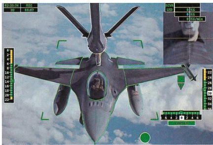
Automatische Luftbetankungsanlage A3R von Airbus.
