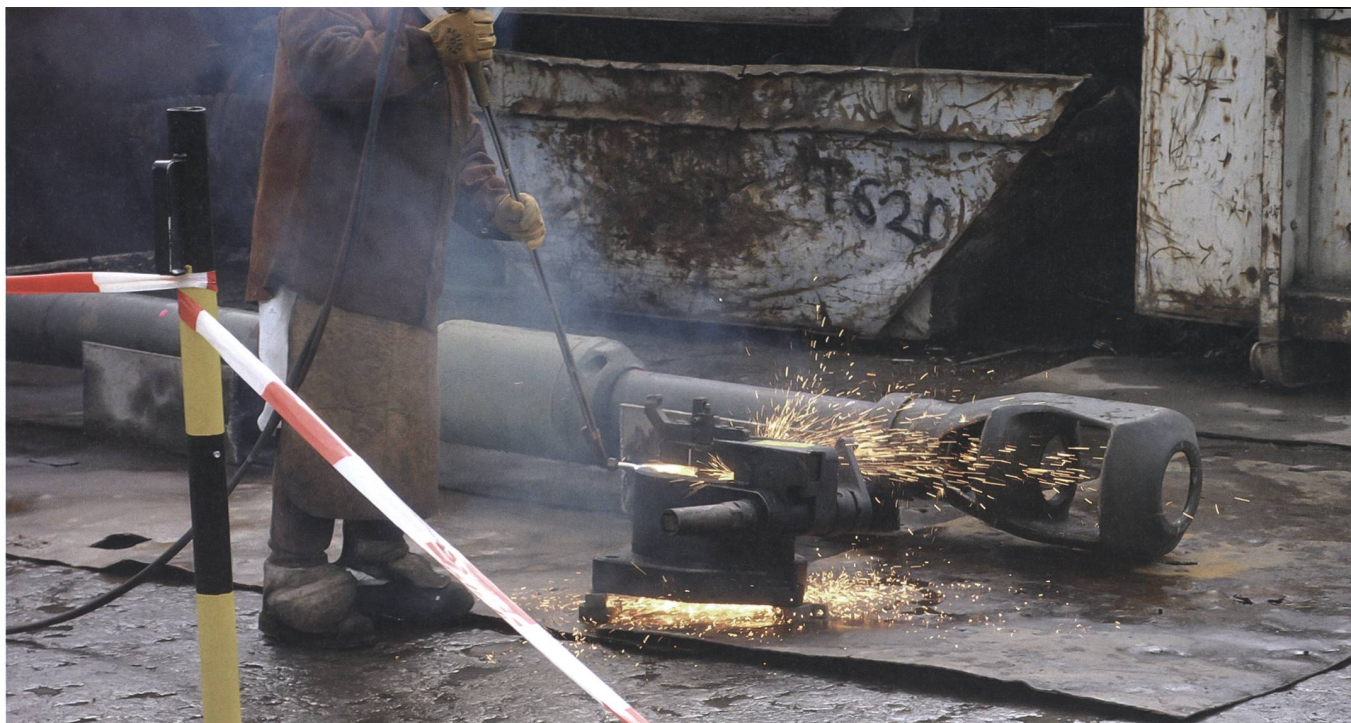
Ein Mitarbeiter zerschneidet ein Kanonenrohr in kleine Stücke, damit dieses nicht mehr eingesetzt werden kann.
