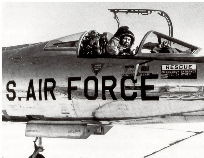
Chuck Yeager im Cockpit der Lockheed NF-104, die mit einem zusätzlichen Raketentriebwerk ausgerüstet war und Höhen von über 35 000 Meter über Meer erreichen konnte.
