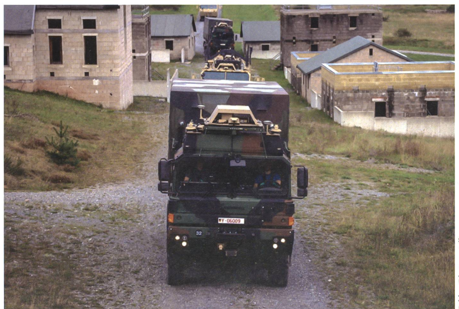
Im Konvoi unterwegs. Hier im Bild: zwei HX2-LKW, die jeweils mit einem Autonomie-Kit ausgerüstet sind und sich wechselseitig in einem Leader-Follower-Prinzip folgen.
