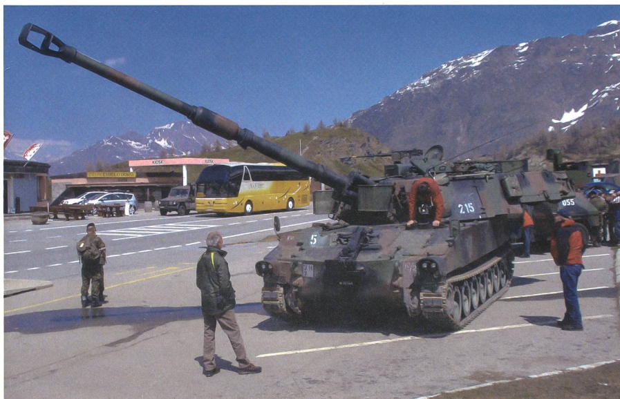
Die neueste kampfwertgesteigerte Version der Pz Hb M-109 auf dem Simplon. Das Rohr L47 weist jetzt eine Länge von 7,35 m (Rohrlänge des L39 Geschützes 6,20 m) auf.
