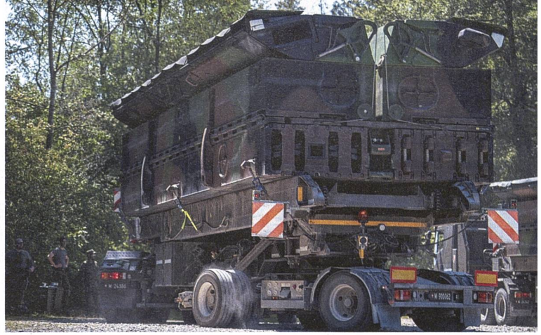
Brückenteile der Pontoniere werden mit Lastwagen zum Zielort transportiert.
