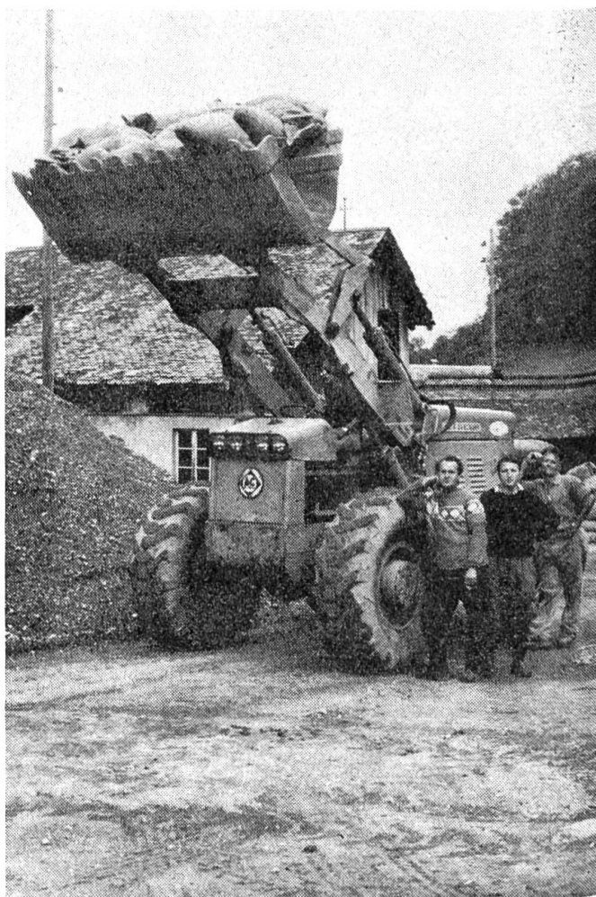
Der Riesentrax mit unserer Kies- und Sandladung — so werden die Säcke zum Lastwagen gefahren und dort abgeladen.
