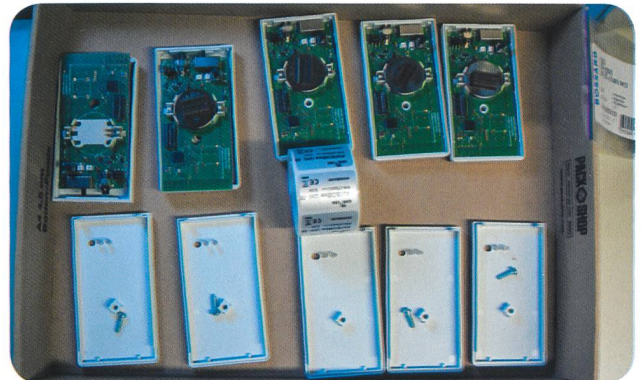
Manche Geräte werden extern produziert und intern mit Zusatzteilen versehen. Wie hier ein Lichtsignalanlage-Sender.
