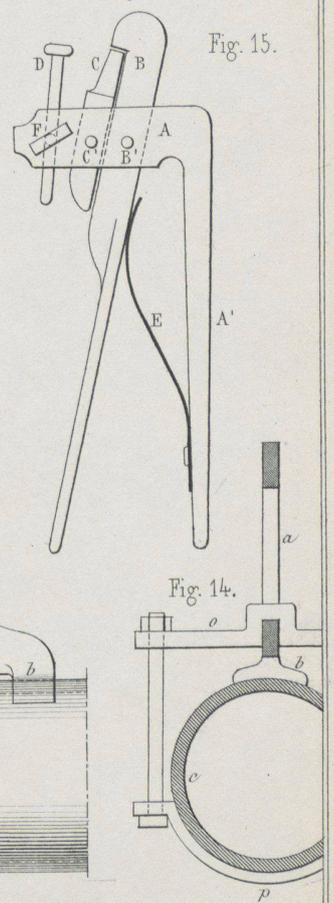
11-14. Apparate zum Anbohren gefüllter Gas- oder Wasserleitungsröhren. Maßstab 7/8.
