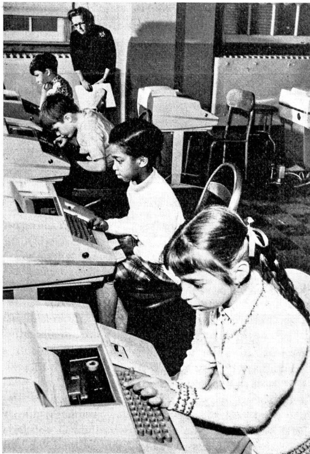
Kinder erhalten täglich Unterricht im Rechnen mit Hilfe eines Computers (RCA Spectra 70), der sich in einem Computer-Zentrum befindet und 200 Schul-Terminals bedient.
