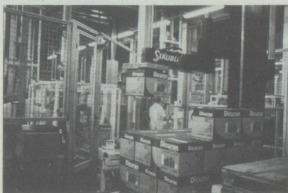
Bras automatique pour mise des cartons sur palette
