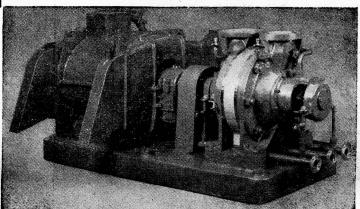
BOILER FEED PUMPS FOR NUCLEAR POWER STATIONS
