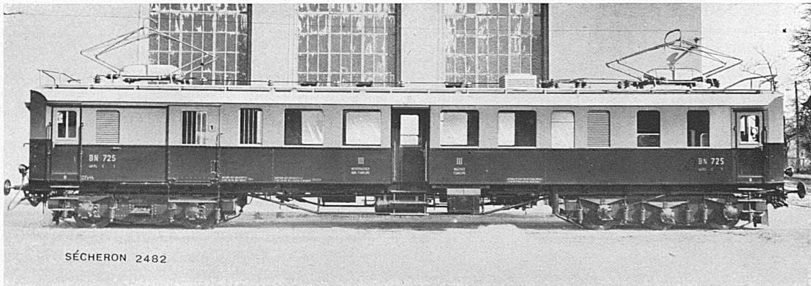
Automotrice CFe 4/5 de 1440 ch pour la Compagnie du Chemin de fer Berne—Neuchâtel. Vitesse normale 50 km/h, vitesse maxima 90 km/h
