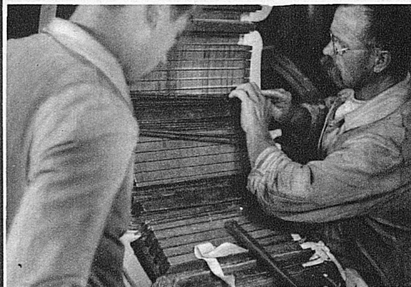
Einlegen der Statorwicklungen
