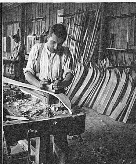
Feingefühl erfordert das Verputzen der Lauffläche
