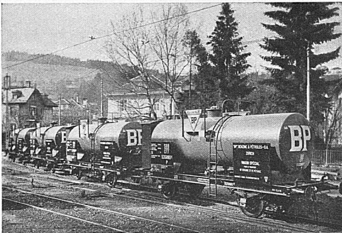
Tankwagen mit elektrisch geschweissten Kesseln zum Transport von Benzin und Petroleum
