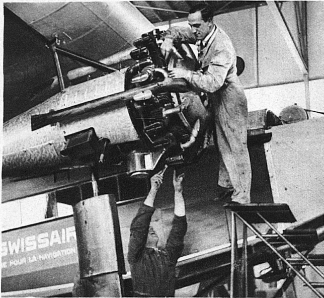
Das Herz des Flugzeuges, der 300 PS Wright-Motor, wird vor Antritt eines jeden Fluges durch Spezialisten sorgfältig geprüft
