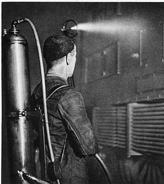
Der sogenannte Lokomotivkasten wird nicht mit Wasser abgespritzt. Er erhält eine Oeldusche, damit sein Glanz nicht verloren geht — La carrosserie est préalablement passée à l'huile
