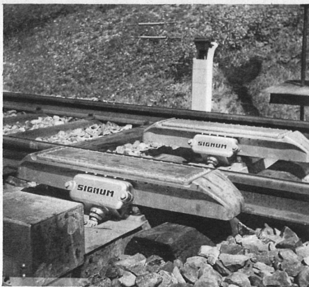
Links: Automatische Bremsung durch « Signum » — A gauche: Freinage automatique « Signum »
