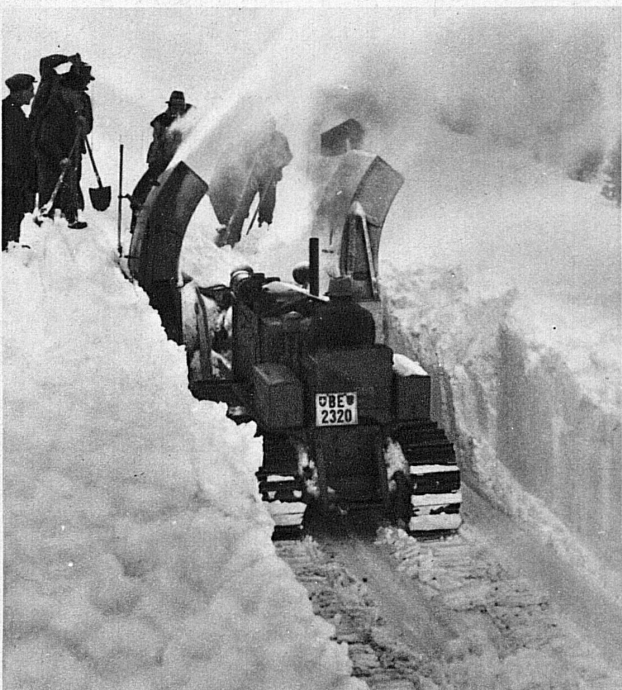
Der Schnee kann durch die drehbaren Kanäle nach derselben Seite geworfen werden – Utilité des canaux tournants
