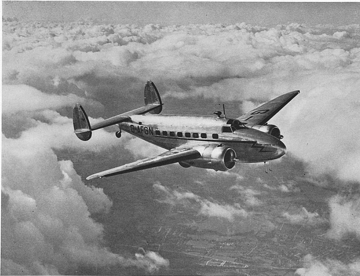
A gauche: Sur la ligne directe Londres-Bâle-Zurich, les British Airways ont mis en service cette année les célèbres avions Lockheed 14, pouvant transporter 9 passagers, et réalisant une vitesse de croisière d'environ 300 km/h.
