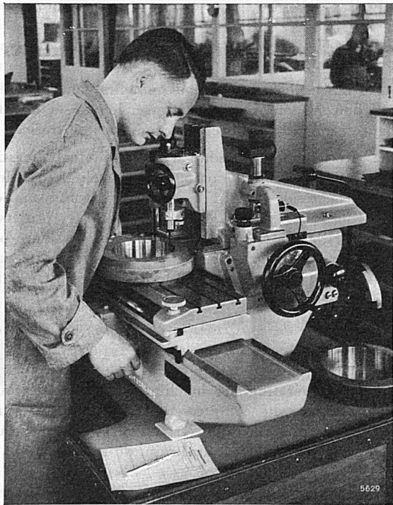
Fig. 3. Contrôle d'une bague sur appareil à mesurer SIP.
