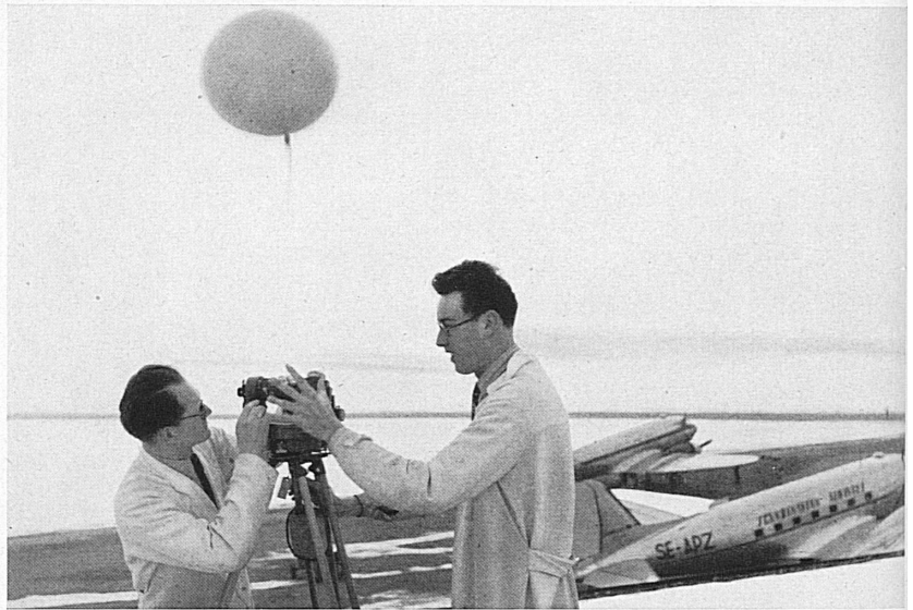
Mit dem Theodoliten wird die Flugbahn eines Registrierballons verfolgt und damit Stärke und Richtung des Windes in den verschiedenen Höhen festgestellt.
