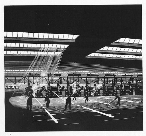
ie Halle des Walzwerks spannt sich breit und lang über eine weite Fläche aus stählernen Rollen und Platten. Quer durch die Halle hängt die Kommandobrücke, quer durch die Halle steht die Gruppe der Walzgerüste, die Walzenstraße. Am Kopf der Halle ist der mächtige Ofen gebaut, der die Stahlblöcke auf Weißglut erhitzen muß. Männer ziehen den Block mit langen Zangen aus dem Ofen und lassen ihn auf die «Fahrbahn», den Rollgang, gleiten.
