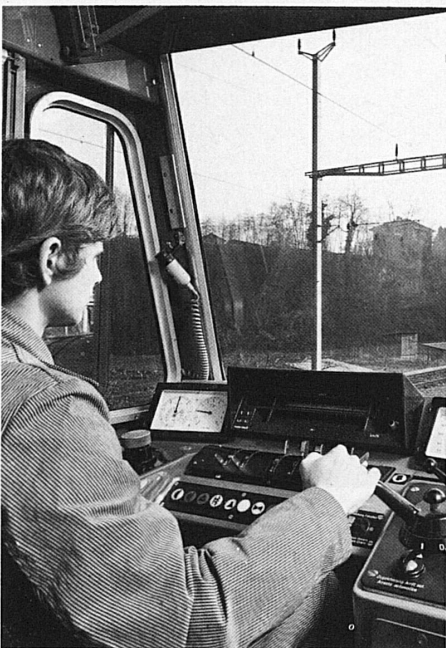
◀ Führerstand eines neuen Vorortszuges der SBB. Im schwarzen Kästchen vor dem Lokomotivführer werden Ist- und Sollgeschwindigkeit sowie weitere wichtige Informationen angezeigt, die über den Linienleiter, ein zwischen die Geleise verlegtes Kabel, mit Hilfe elektromagnetischer Felder übermittelt werden. Photo SBB
