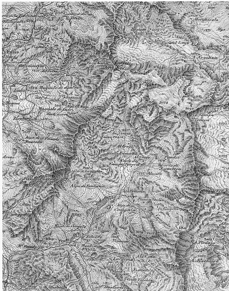
Ausschnitt aus den Vermessungsgrundlagen zu Siegfried-Blatt 507, Peccia (1853) / Fragment des relevés pour la feuille 507 de la carte Siegfried, Peccia (1853) / Dettaglio di un rilevamento per il foglio 507 della carta Siegfried, Peccia (1853) / A sample of the survey data used for Sheet 507 of the Siegfried map, Peccia (1853)
