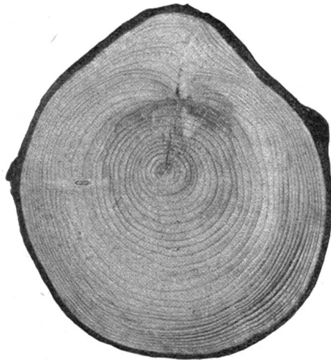
Bild 4. Trockenrisse an Fichte. (Aus: „Holzfehler“.)
