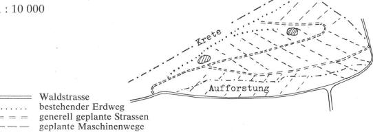
Erschliessung auf traditionelle Art mit hoher Fahrwegdichte (96 m'/ha). Feinerschliessung mit Maschinenwegen (85 m'/ha).
