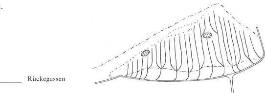
Es werden keine zusätzlichen Strassen gebaut, der bestehende Basisweg genügt. Das ganze Gebiet wird mit Rückegassen feinerschlossen. Der Einsatz eines speziellen Rückefahrzeuges, Knickschleppers, ist erforderlich. Wegnetzdichte: nur Basisstrasse 41 m'/ha. Der Rückegassenabstand beträgt rund 30 m, bestehende Reistzüge werden einbezogen. Jede Rückegasse verläuft in der Fallinie. Interessant dürfte sein, dass der Schneisenaushieb für die 26 Rückegassen nur 4 % des Vorrats ausmacht.
