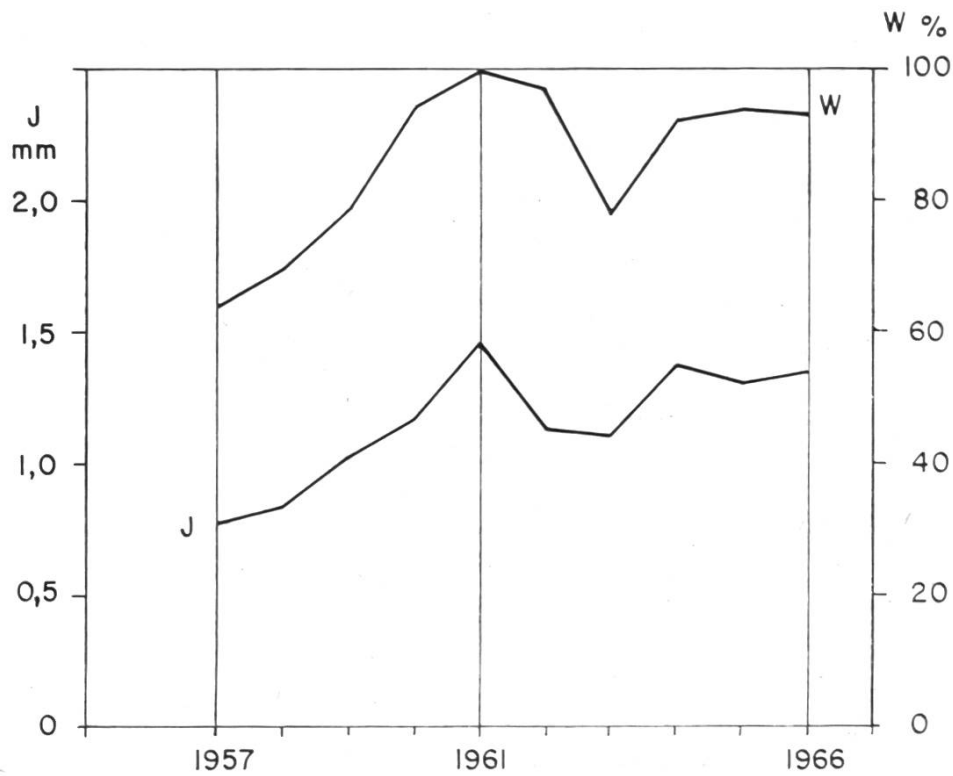
Abbildung 1. Jahringbreite F-beeinflusste Fichten im «Heimeholz» (J, linke Ordinate) und relativer Wasserverbrauch (W) der Gaswaschanlage (Abluftreinigungsanlage) der Aluminiumfabrik (rechter Ordinatenmassstab) für die Jahre 1957 bis 1966.
