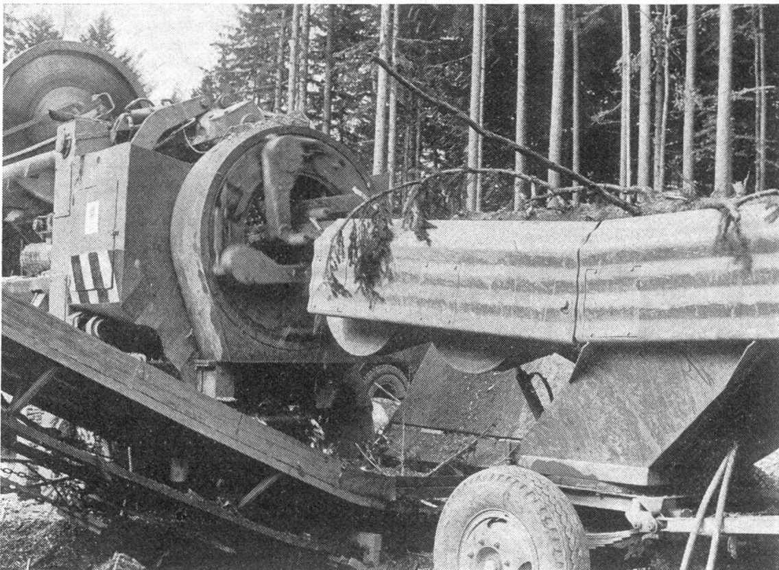
Abbildung 2. Die Entastungsmaschine System Auböck ist technisch zwar gut, die Vollbaumernte wird jedoch vom Waldbau begründet abgelehnt.
