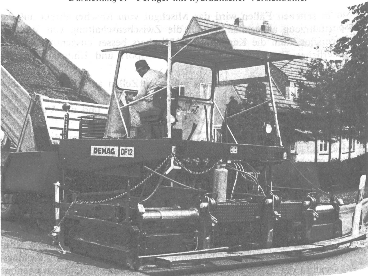
Darstellung 5. Fertiger mit hydraulischer Verstellbohle.
