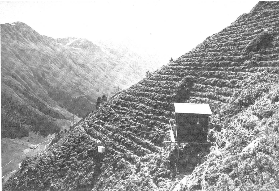
Abbildung 4.1 a. Gaswechsellmessplatz in der Grossen Runse. Rechts im Vordergrund liegt der gut-besonnte, ostexponierte und links (weisse Wetterhütte) der nordexponierte Standort. In der Hütte befinden sich die Mess- und Regelgeräte.
