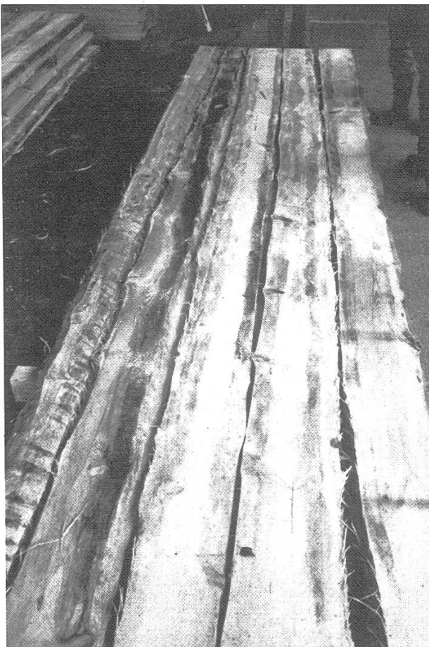
Abbildung 7. Holzlagerungsversuche und Schutzmitteltest – Verblauung des Kontroll-Schnittholzstapels nach dreimonatiger Lagerung (Kiefern Bretter).
