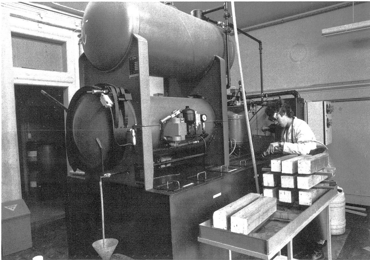
Abbildung 5. Kesseldruck-Imprägnieranlage. Versuche zur Imprägnierbarkeit der Weisstanne (Vorhaben im Rahmen des Nationalen Forschungsprogrammes Holz).
