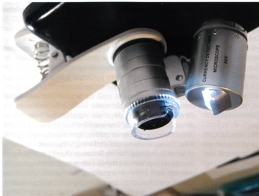
Fig. 11 Disposition d'un microscope sur un téléphone portable Abb. 11 Mikroskop mit einem darauf montierten Mobiltelefon
