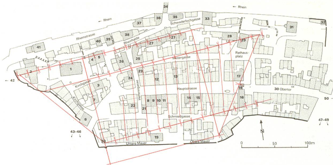
Abb. 6. Hofstätten-Absteckung nach der Grundgeometrie, schematische Rekonstruktion. Der östliche Dreiecksversatz und damit der Hofstättenverlust am Rheinbord ist durch eine Drehung des Hofstättenrasters kompensiert. Dem sekundären Lineament folgen vor allem die später abgesteckten Hofstätten am Markt (Hauptstrasse).
