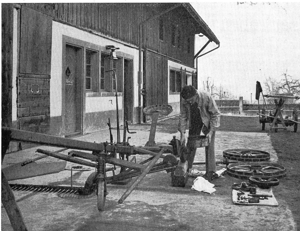
Illustration 1: Révision et nettoyage complet d'une faucheuse.
