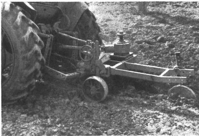
Fig. 1: charrue Civello montée sur un tracteur «Eron» de 15 CV.
