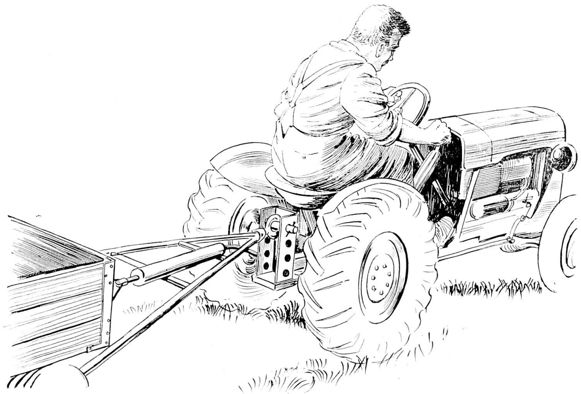
Fig. 1: Le dispositif de commande hydraulique Tétrax 303 pour freins de remorque mécaniques garantit une sécurité entière pendant la marche. La remorque est freinée sûrement et sans peine depuis le siège du conducteur.
