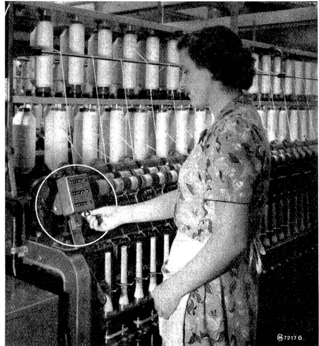
Abb. 3 — Auf einer Ringspinnmaschine montierter Produktionszähler für Dreischichtbetrieb.
