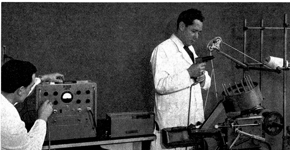
Mit diesen elektronischen Fadenspannungs-Meßeinrichtungen werden an den «Schweiter»-Maschinen sorgfältige und genaue Messungen vorgenommen
