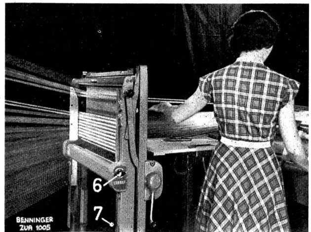
Abb. 6 Einlegen des mehrfachen Fadenkreuzes
